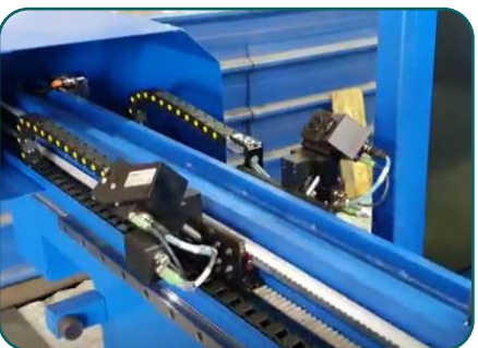
i-mittaus: Taivutuskulman lasermittaus ja reaaliaikainen korjaus (optio).
