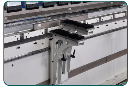
Etuetuet harjoilla, liikkuvat lineariohjaimessa, korkeussäädettävä.
