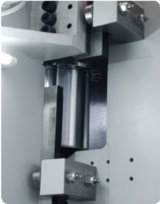
Kaksinkertaiset ylä- ja alarullalaakerit tarkkoihin ja nopeisiin liikkeisiin.
