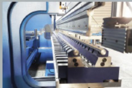
Säädettävä V-alatyökalu, V=25 - 400mm.
