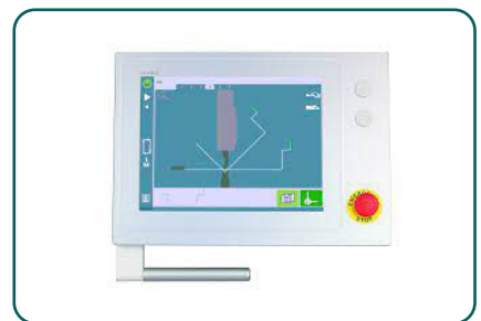
2D-grafiikkaohjain, 15" kosketusnäyttö, CybTouch15, mukaan lukien kosketusprofiili toiminto ja automaattinen taivutusjärjestyksen laskeminen.
