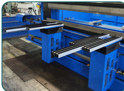
ASF-järjestelmä: Automaattinen levynseuranta.
