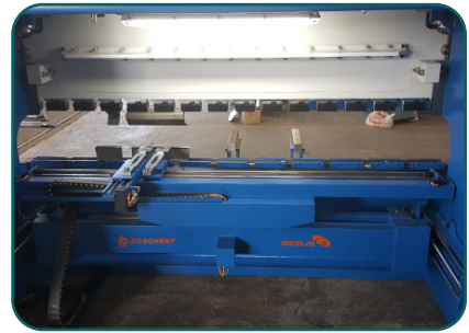
Takavasteiden ohjausjärjestelmä koneen sivulla (vapaata tilaa takana).
