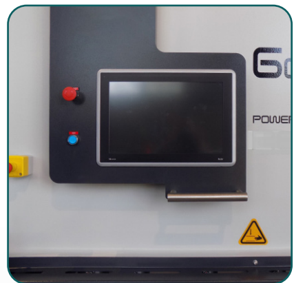
Koneen pituudella liikutettavissa oleva värikosketusnäyttö 15", (optio).
