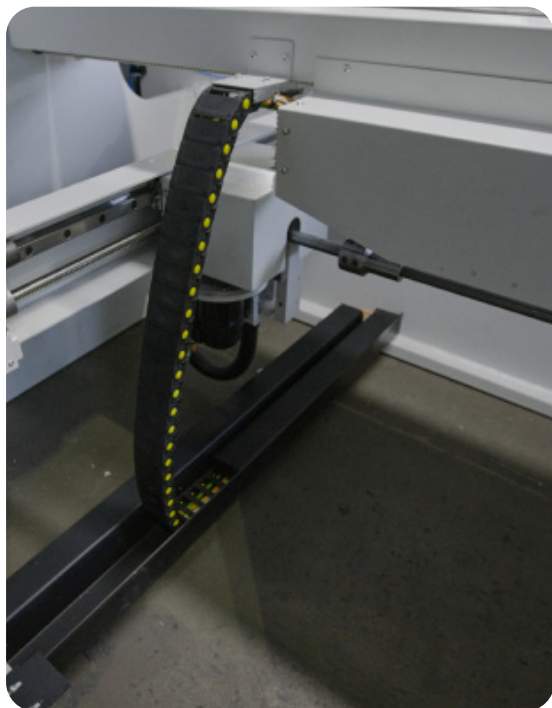
Takavasteiden voimansiirto kuularuuvilla ja tuplalineaarijohteilla.
