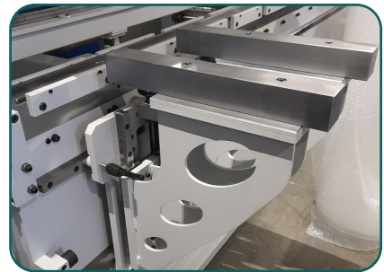
Vahvat etutuet (optio), siirrettävät lineaarijohteilla, korkeussäädettävä.
